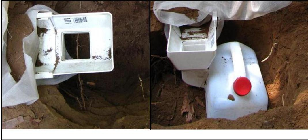
**Figura 41.** Sistema de recolección de lixiviados en la base de la trampa de erosión.
