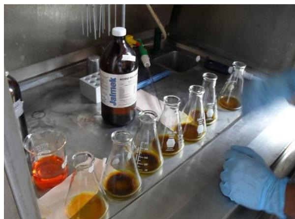
**Figura 14.** Toma de muestras bajo la copa y fuera de la copa del árbol y determinación del contenido de materia orgánica.
