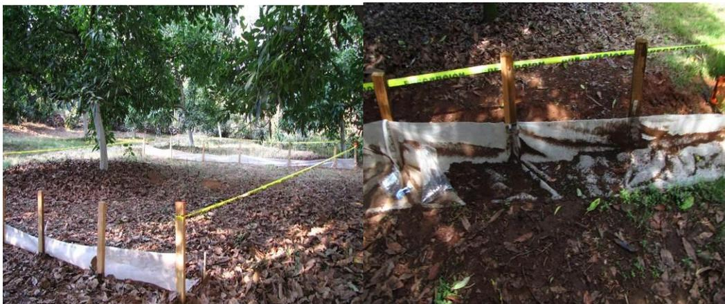
En un área vecina se instaló el sistema de estacas marcadas al nivel original del suelo en una parcela igual y paralela a las trampas de erosión (Vanwelleghem et al., 2010). Se colocaron las estacas en una cuadrícula de 2 x 2 m, con un total de 30 estacas en el área de 80 m<sup>2</sup> (Figura 6). Se midió el cambio de nivel con respecto a la marca original también mensualmente.
